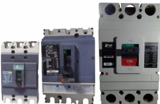
Os disjuntores caixa moldada de modelo HNS e HNE atuam na frequência de 50/60HZ. Os dois modelos tem suas próprias características: HNS: Tensão de isolamento nominal é de 950V, tensão nominal de trabalho 690V ou inferior, a corrente nominal de trabalho é de 12,5A à 630A. HNE: Tensão de isolamento nominal é de CA 690V, corrente nominal de 12,5 à 160A. Eles protegem os circuitos contra sobrecargas, curto-circuito e falta de tensão.
