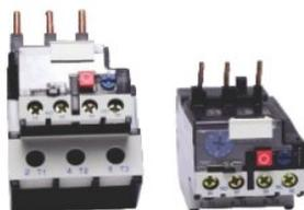
Os relés térmicos UPR2-D13 são feitos para proteger a quebra de fase quando o motor está sobrecarregado. Possui mecanismo diferente de compensação de temperatura e pode ser conectado ao conector CA UP1-D.
